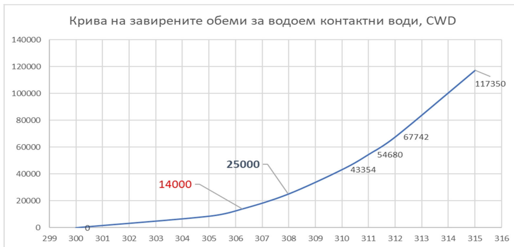
Σχήμα 18: Καμπύλη των αποθηκευμένων όγκων στην κεφαλή CWD, [m 3 ]
